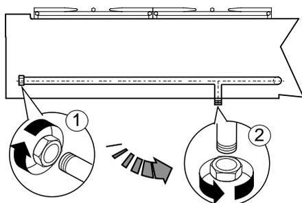
Ad installazione effettuata controllare, con una soluzione di acqua saponata, che non esistano perdite nei punti di raccordo.
