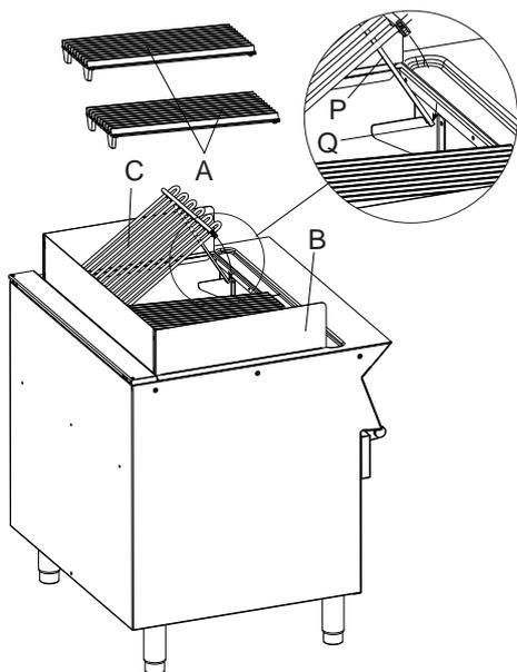
2. Sollevare le resistenze "C" e ruotare di 90°C il puntone "P", posizionandolo nell'incavo del supporto "Q", per mantenerla in posizione.
