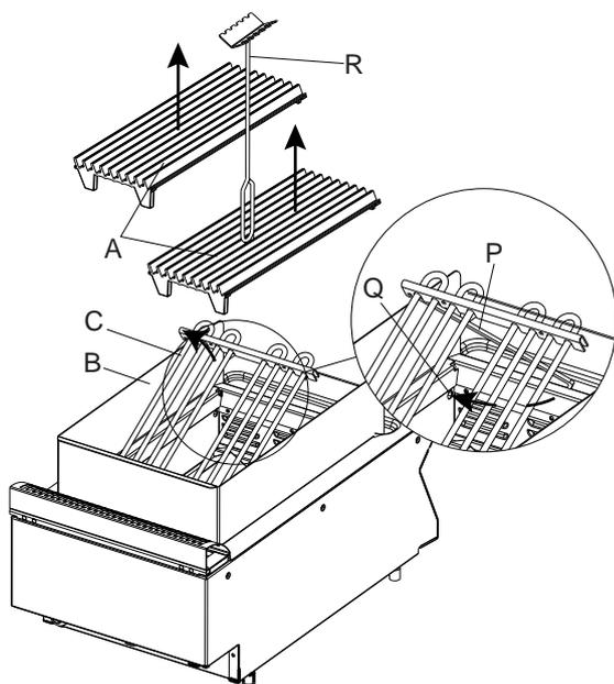
2. Sollevare le resistenze "C" e ruotare di 90°C il puntone "P", infilando il perno nel foro "Q", per mantenerle in posizione.
